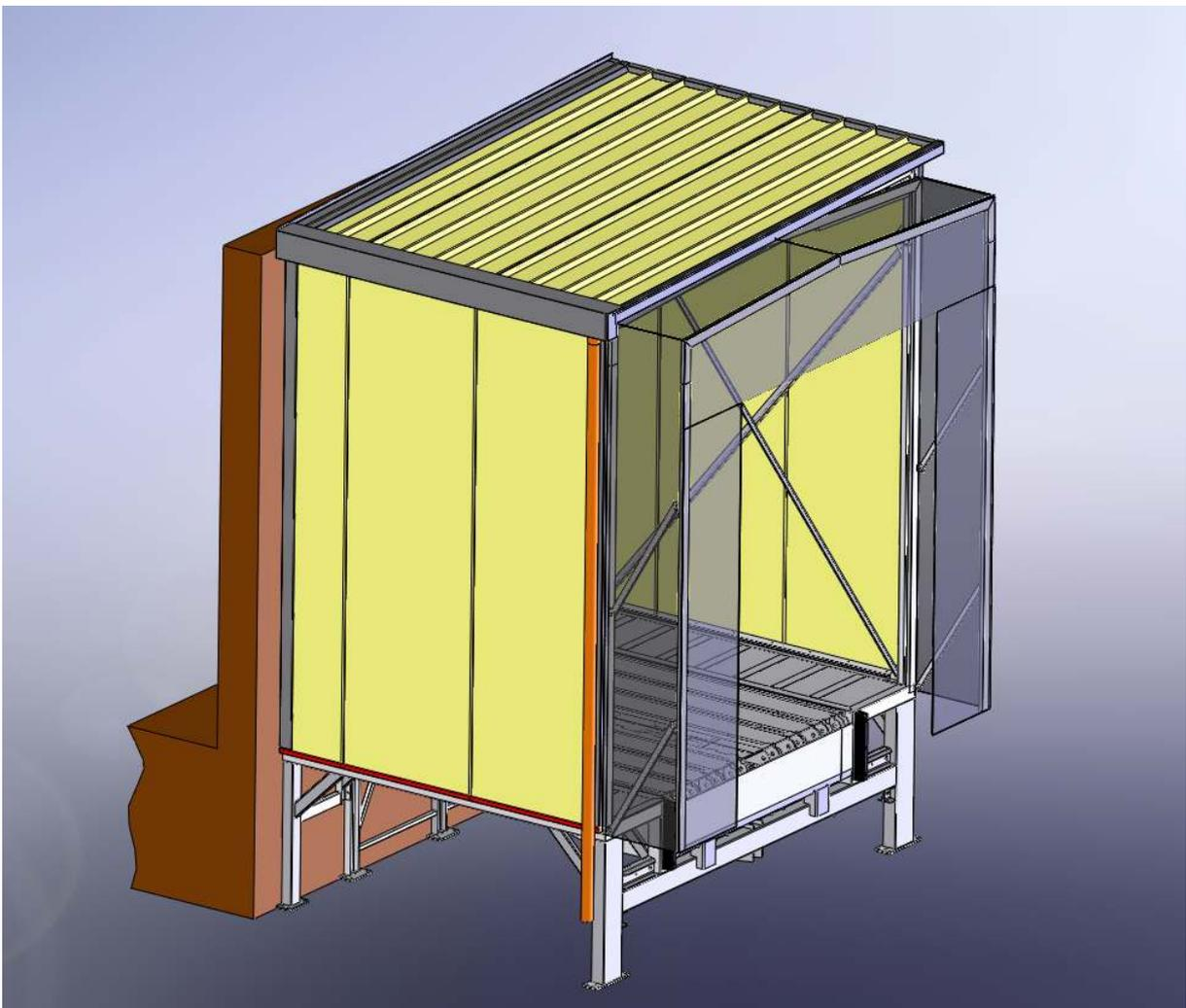
La banchina è costruita in profili di acciaio elettrosaldati zincati a caldo o verniciati Raal 5007. La struttura, assemblata, è autoportante e appoggia al suolo mediante piedi ancorati sul solaio. La banchina viene unita al fabbricato mediante tasselli ad espansione.
